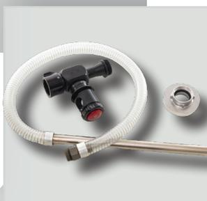
Edutor entre linhas para formação de espuma confeccionado em liga leve de alumínio com cabeça giratória em 360°, autolimpeza, mecanismo destacável e válvula de retenção. Dosagem de concentração regulável de acordo com a necessidade. Sistema de limpeza flush. Tubo Pick Up em material transparente com ponteira em material inoxidável. Conexões de entrada e saída Storz 1.1/2 em liga leve de alumínio.
